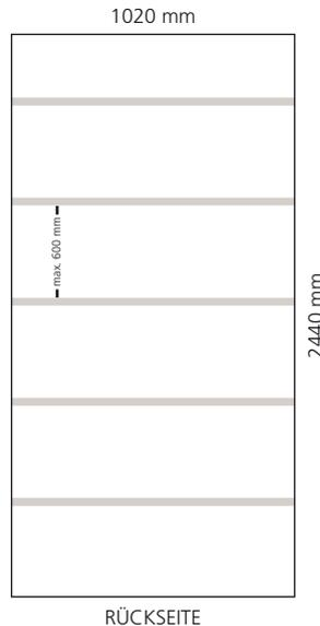
Befestigen Sie im Abstand von **maximal 600 mm** zueinander die Einhängeprofile auf der Rückseite der Lamellenwand.
